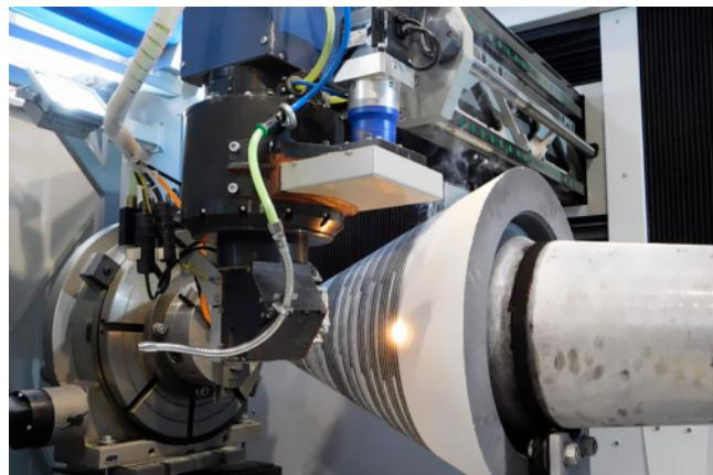
**Лазерная закалка** основана на быстром нагреве зоны обработки выше температуры фазового перехода и последующем охлаждении за счет теплоотвода во внутренние объемы материала. В результате в поверхностном слое образуется специфическая высокодисперсная структура, имеющая микротвердость в 2—4 раза превышающую твердость основы.
