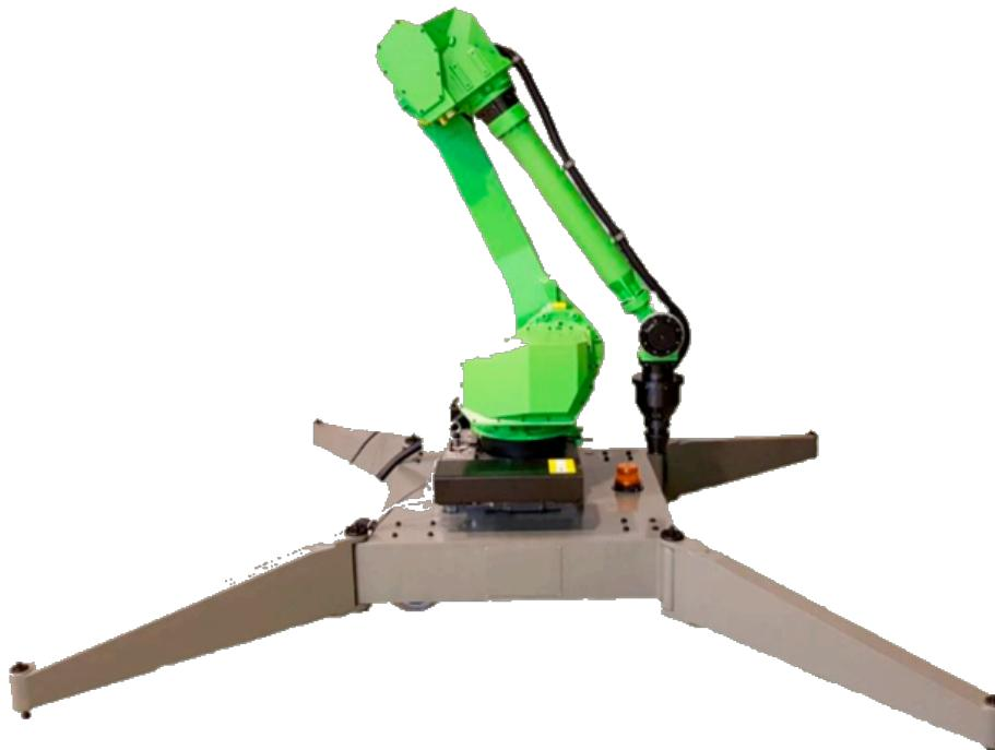
Роботизированный лазерный комплекс для повышения износостойкости поверхностей деталей с возможностью проведения обработки на территории предприятия заказчика.
