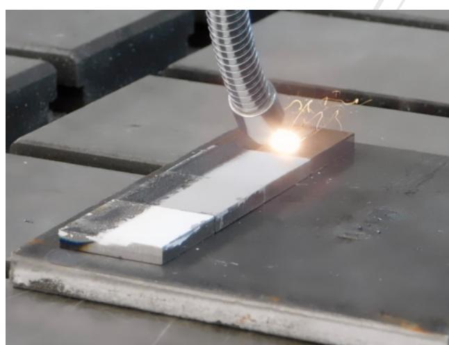
**Лазерное легирование** заключается в насыщении материала легирующими элементами посредством диффузии предварительно нанесенного слоя под воздействием лазерного пучка.
