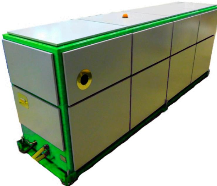
Универсальный многолучевой CO<sub>2</sub>-лазер для выполнения операций резки, сварки, наплавки и термообработки широкой номенклатуры деталей из различных материалов. Источник состоит из 6 трубок излучателя и отличается высоким качеством излучения (максимальная расходимость 0,8 мрад), излучатель защищен патентом на изобретение RU 2703609.
