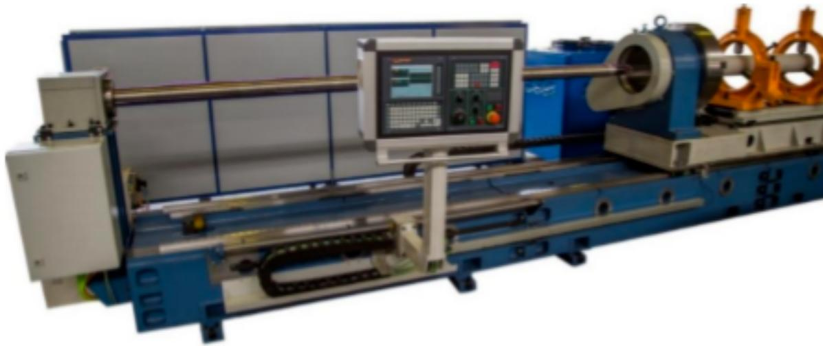
Автоматизированный лазерный технологический комплекс для повышения износостойкости внутренних поверхностей цилиндрических деталей длиной до 6 м.
