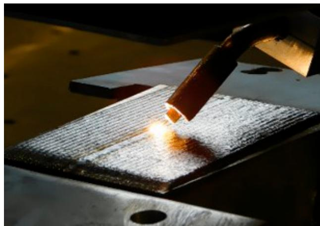
**Лазерная наплавка** поверхности металла – это эффективный способ восстановления изношенных или улучшения прочностных характеристик новых деталей механизмов и машин. Процесс заключается в нанесении расплавленного материала на обрабатываемое изделие, поверхность которого разогрета до температуры плавления.
